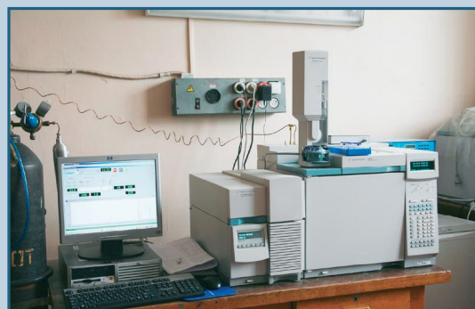
● Хромато-массо-спектрометрическая система Agilent 6890N/5973N для идентификации сложных соединений
